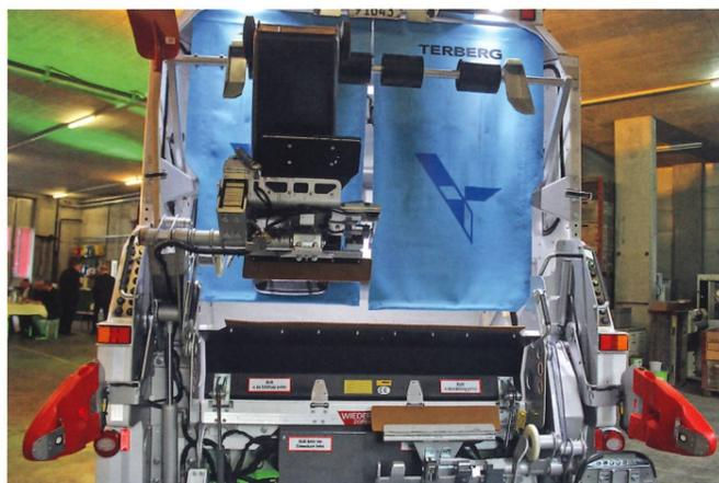
Die Terberg-Befüllungsanlage zeigte, wie sicher und schnell der Abfall in die Grube geleert und dabei das Gewicht ermittelt wird.
